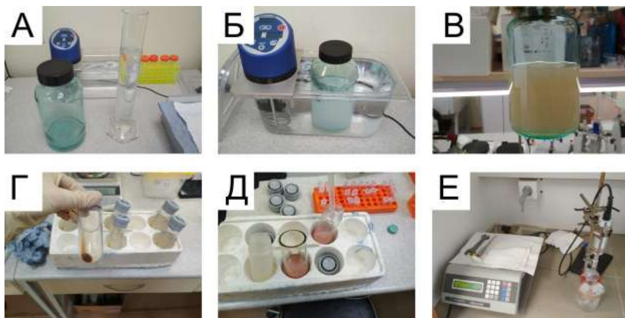
Рисунок 4.14 – Стадии синтеза желатиновых наночастиц. (А) Растворы желатина и изопропилового спирта перед смешиванием; (Б) инкубация наночастиц на водяной бане; (В) внешний вид суспензии наночастиц после добавления глутарового альдегида; (Г) осадок наночастиц после центрифугирования; (Д) объединение промытых наночастиц желатина перед финальной обработкой ультразвуком; (Е) ультразвуковая обработка наночастиц на льду.
