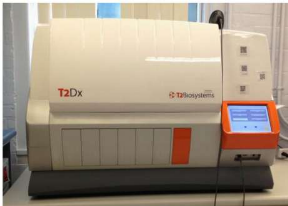
Рисунок 1.8 – Настольный прибор для ЯМР-анализа от фирмы T2 Biosystems (перепечатано с изменениями из [389]).
